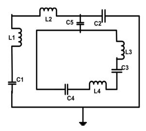
Fig.8.Unit Cell – Equalent Circuit.
